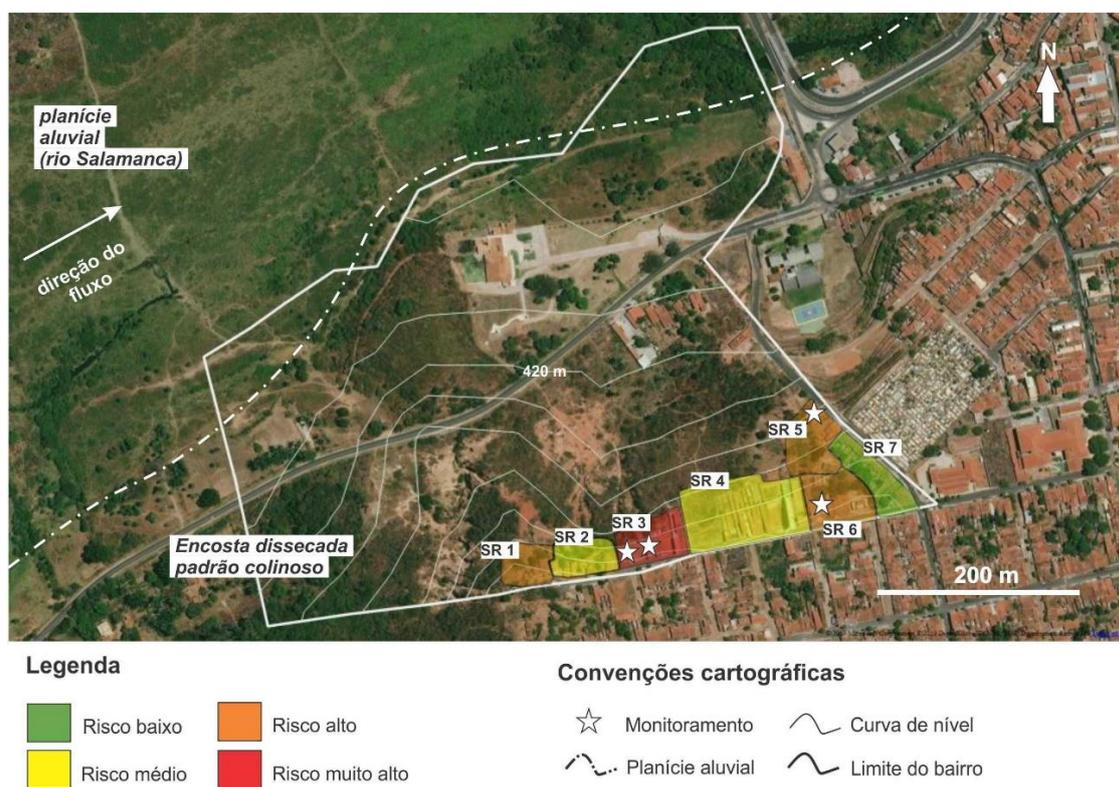
O setor de risco 1 (SR1) tem uma área aproximada de 234 m<sup>2</sup> e 66 metros de altura da planície ao topo da colina e declividade maior que 75%. Os processos atuantes identificados foram erosão por sulcos e ravinas severa e profunda evidentemente causada pela retirada da vegetação do topo.
