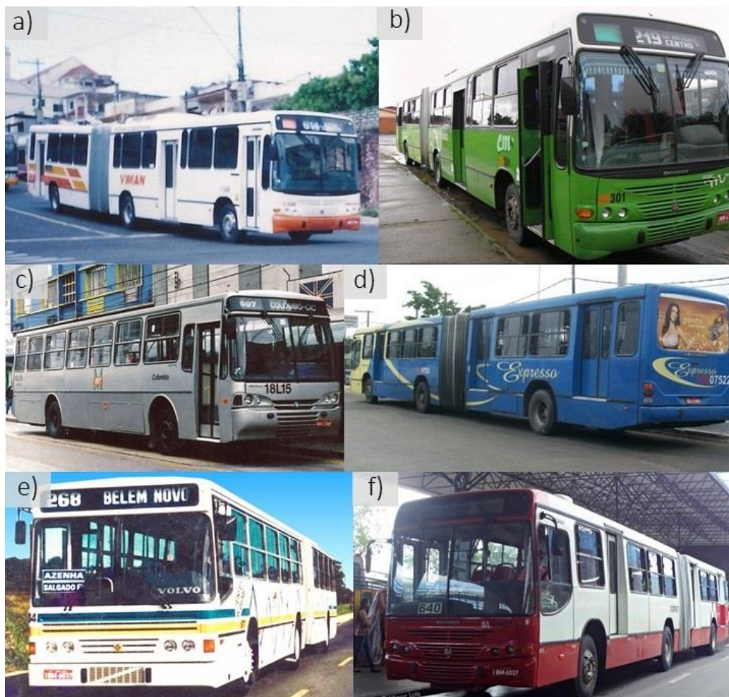
Figura 4. Ônibus articulados da cidade de Manaus: a) e b) ônibus que tiveram o chassi transformado de convencional com dois eixos para chassi articulado com três eixos; c) e d) ônibus de chassi Volvo convencional que foi transformado em articulado e reencarroçado; e) e f) ônibus que passou por reencarroçamento.
