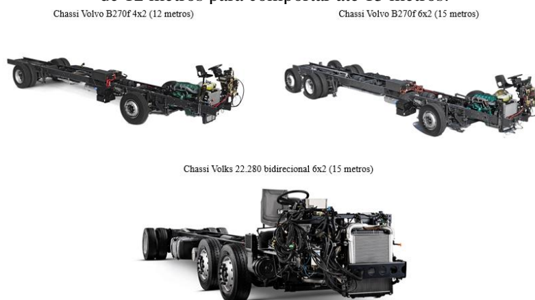
Figura 10. Tipos de configurações estabelecidas a partir da adaptação do chassis para carrocerias de 12 metros para comportar até 15 metros.
