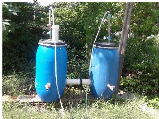
uma mangueira de cozinha acoplada para a retirada do gás gerado a partir da decomposição do material (Figura 1).
