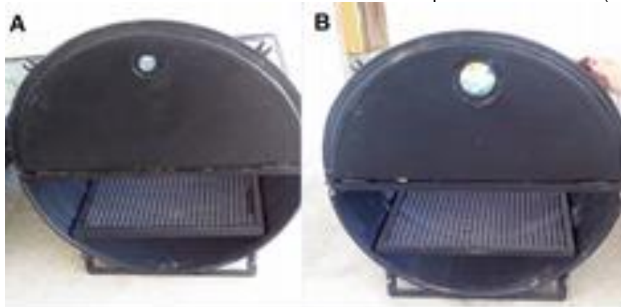
Figura 2. Versão 2.1 do secador solar de baixo custo com orifício de 24 mm para saída de ar frio (A) versão 2.1 do secador solar de baixo custo com orifício de 57 mm para saída de ar frio (B).
