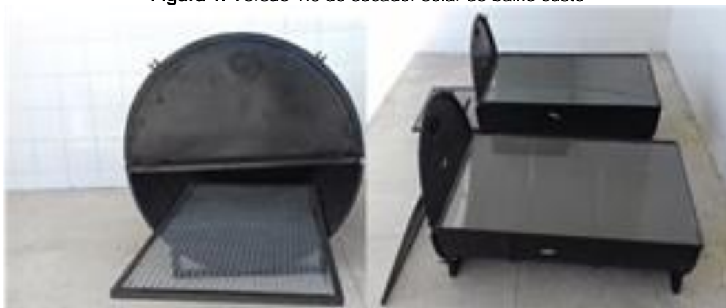
Figura 1. Versão 1.0 do secador solar de baixo custo
