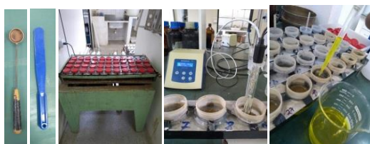
Figura 1 - Determinação do pH em água e SMP. (a) instrumentos usados para medição do volume de solo; (b) agitação horizontal; (c) medição do pH em água; (d) adição da solução SMP.
