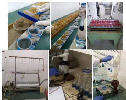
Figura 2 - Determinação de Ca, Mg e Al no solo. (a) Medição do volume de solo; (b) adição de extrator KCl; (c) homogeneização; (d) sistema de medição de alíquotas; titulação do Ca+Mg com EDTA (e) titulação do Ca com EDTA.
