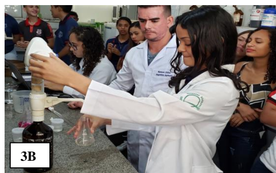
Figura 3: Quantificação da acidez no solo, realizada por meio da técnica volumétrica de titulação.
