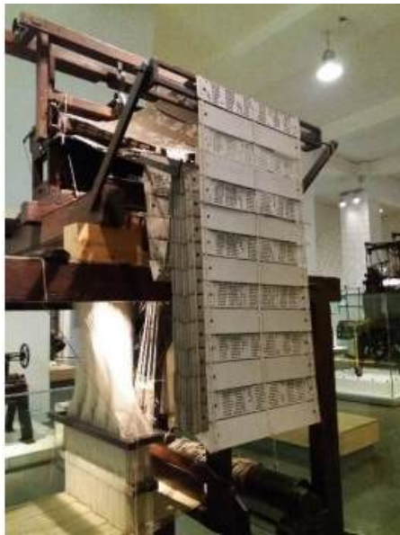
Tear de Jacquard. Foto do arquivo pessoal da pesquisadora. The Science Museum of London
