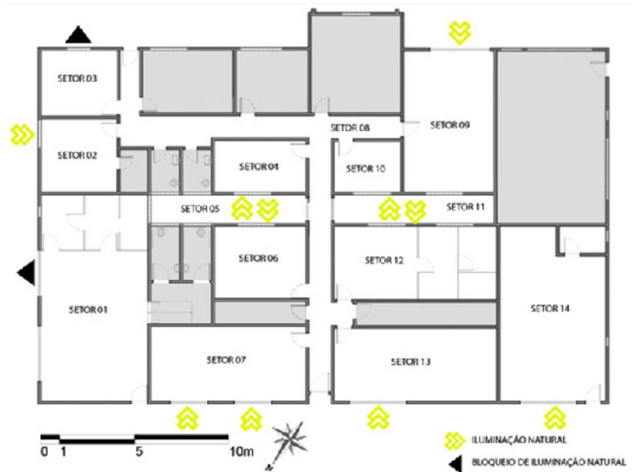
A configuração espacial da edificação conta com duas áreas, setor 05 e 11, destinadas ao auxílio da ventilação e iluminação natural e que a construção conta com várias aberturas em sua fachada (Figura 3). Porém, como visto na Figura 3 e na Figura 4, há pontos de bloqueio para iluminação e ventilação em algumas esquadrias, elementos como por exemplo, móveis e divisórias.
