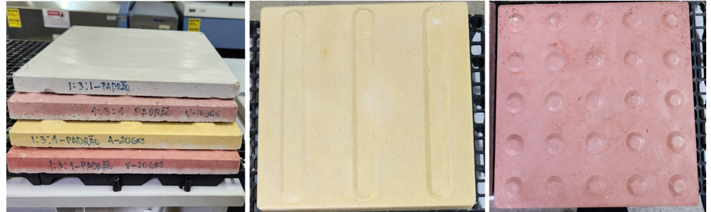
Figura 6 – Testes com incorporação de fibras à argamassa e com adição de corantes Fonte: Autores (2024)
